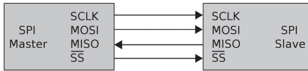
Figura 11.3 – Barramento da SPI: mestre e escravo únicos (imagem cortesia de Colin M. L. Burnett).
