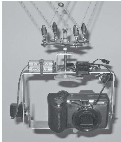
Figura 9.9 – Equipamento com capacidade pan/tilt, feito para uma câmera utilizando dois servos (imagem por David Mitchell).
