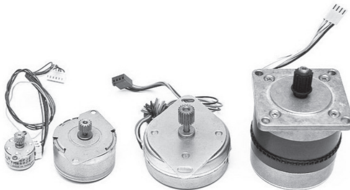
Figura 10.3 – Tipos diferentes de motores de passo (imagem por Aki Korhonen).
