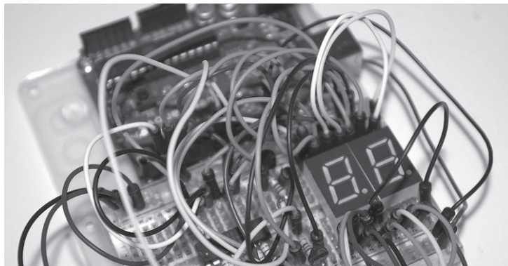
Figura 7.7 – Display LED de sete segmentos (imagem por Tony Jewell).
