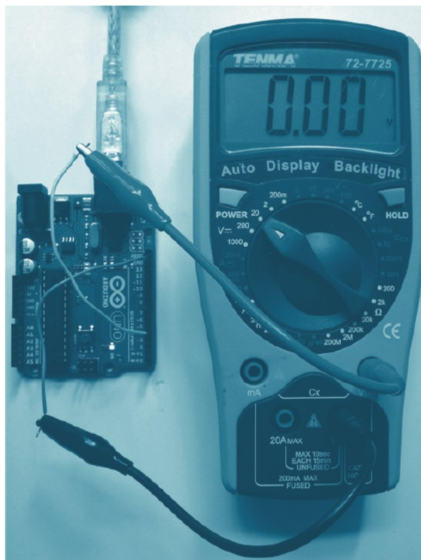
Figura 6-1 Uso de um multímetro para medir as saídas.
