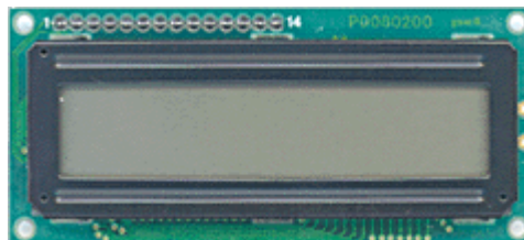
Display Hitachi HD44780 de duas linhas com 16 caracteres por linha
