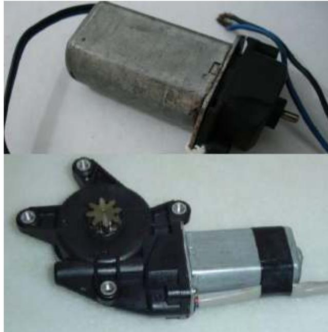
Além do acionamento elétrico, os motores CC de baixa potência utilizados em automação e robótica, apresentam geralmente uma caixa de redução, que é um equipamento composto por engrenagens, com o intuito de reduzir a velocidade de rotação do eixo (ou angular) e aumentar o torque do motor. O torque varia em função da força aplicada ( $F$ ) e do raio de giro (nas engrenagens é a metade do diâmetro primitivo), segundo a equação  $T = F \cdot r$ .
