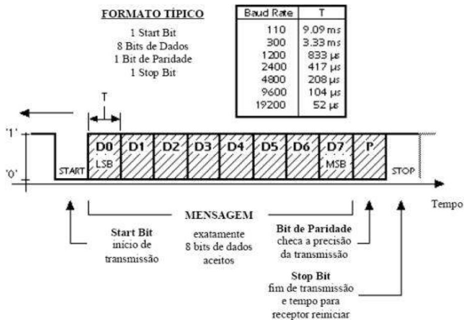
A interrupção do canal serial é utilizada quando se espera *receber* um dado em tempo aleatório enquanto se executa outro programa. Quando o dado chega, o start bit (nível lógico baixo) aciona a interrupção, previamente habilitada, onde a recepção da comunicação serial é executada. Caso o canal serial seja utilizado somente para *transmissão* de dados, não é necessário habilitar a interrupção serial.
